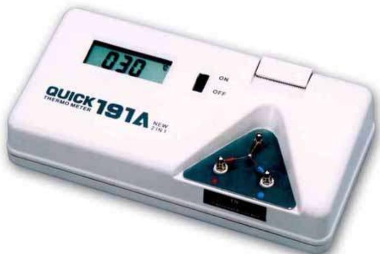
Цифровой измеритель температуры модели 191А предназначен для быстрого и точного измерения температуры наконечника паяльника посредством терморпары диаметром 2 мм, устанавливаемой на панели прибора. В приборе также предусмотрена выносная терморпара, предназначенная для измерения температуры на поверхности компонентов или печатных плат, а также в [тиглях, паяльных ваннах](#) и других применениях.
