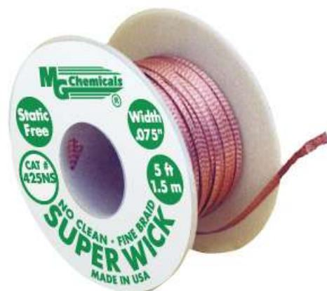
Плетёнки серии 400NS предназначены для удаления припоя при производстве ремонта изделий электронной техники. Изготовлены из высококачественной меди с большим количеством плетений, позволяя, тем самым впитывать больше припоя на единицу длины, чем другие плетёнки. Применяется флюс типа NC (No Clean) – не требует отмывки. Катушки выполнены из антистатического материала.
