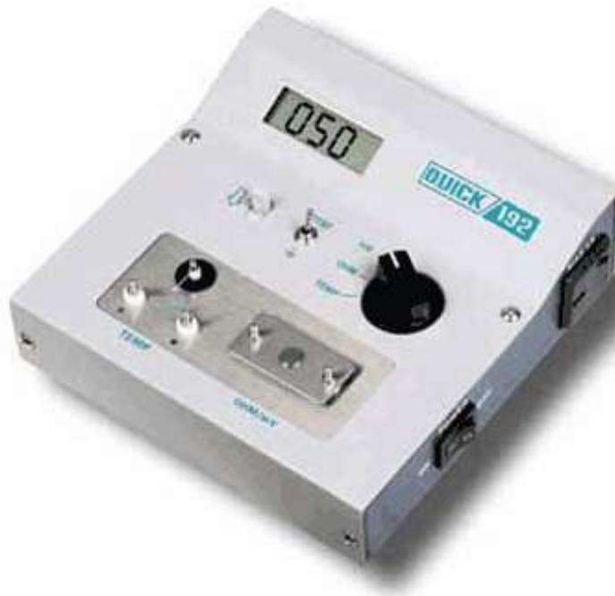
Цифровой измеритель **192** предназначен для проведения комплексных измерений таких важных параметров паяльных станций, как:
