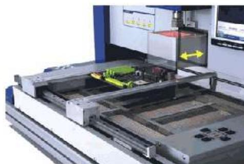
Быстрые и точные перемещения печатной платы, повороты сопла нагревателя и управление встроенной камерой позиционера осуществляются при помощи джойстика.
