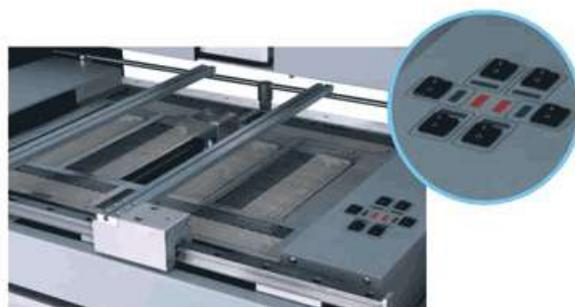
Многосекционный нижний инфракрасный подогреватель мощностью  $400 \text{ Вт} \times 8 = 3200 \text{ Вт}$  и размерами  $550 \text{ мм} \times 450 \text{ мм}$  осуществляет подогрев печатной платы с отдельной регулировкой секций подогревателя, большие размеры подогревателя предохраняют печатную плату от неравномерного нагрева и коробления.
