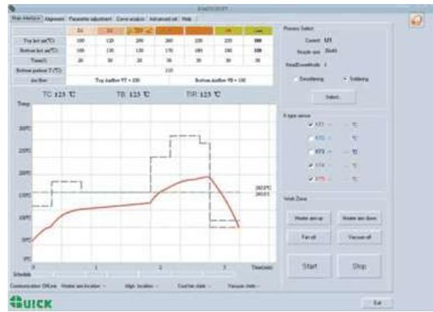
Составление термопрофиля как для монтажа, так и для демонтажа ИМС с учётом её габаритов.
