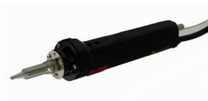
**DIA60** – вакуумный паяльник мощностью 60 Вт. Предназначен для демонтажа компонентов навесного монтажа, а также для удаления остатков припоя с контактных площадок печатных плат. Используется со станциями 968, 988, 988D.
