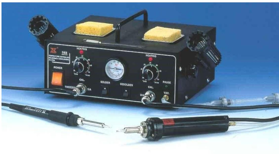
**988 – двухканальная паяльная станция с аналоговыми регуляторами температуры, светодиодными индикаторами нагрева температуры.** Станция имеет два независимых канала:
