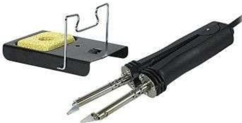
**TWZ-80** – термопинцет мощностью 80 Вт (2 × 40 Вт). Предназначен для демонтажа чип компонентов, а также компонентов в корпусах DIP, SOT, SOP, SOIC, SOJ.
