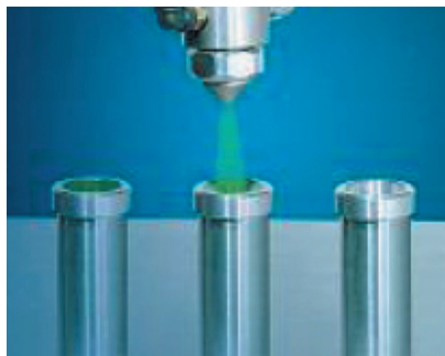
Рисунок 8 Аэрозольный клапан в рабочем режиме
