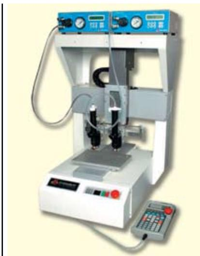
**Рисунок 1** Настольный координатный робот EсоEсо-331
