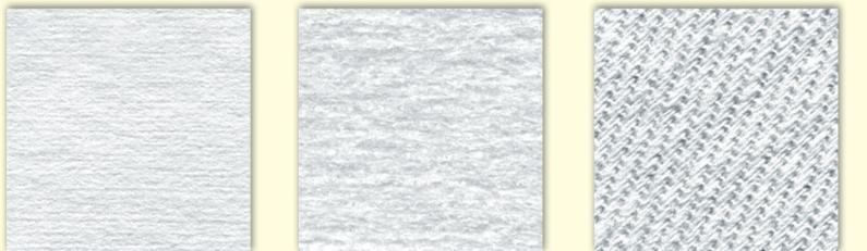
**Рисунок 9** Сухие салфетки: Optiwipes для оптики (а); суперабсорбирующие Hydrowipes (б); хлопчатобумажные с диагональным плетением (в)
