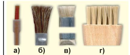
**Рисунок 12** Кисти: для нанесения материалов (а); из конского волоса (б); двухсторонняя из конского волоса (в); из свиной щетины (г)
