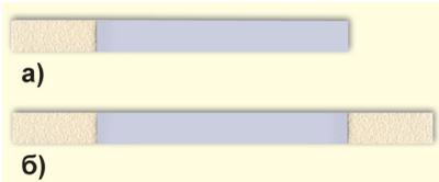
**Рисунок 1** Замшевые тампоны: на одной стороне рукоятки длиной 10 см (а); на двух сторонах рукоятки длиной 12.5 см (б)
