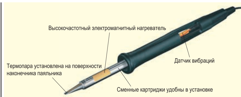
Рисунок 8 Конструкция паяльника станций серий 202х и 303х
