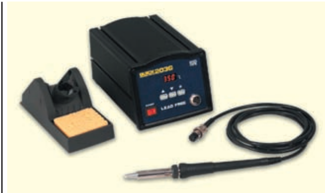
Рисунок 6 Цифровая паяльная станция повышенной мощности 203G
