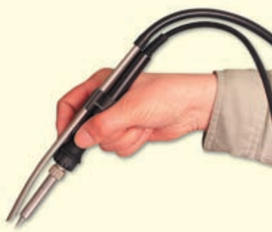
Рисунок 26 Дымоуловитель системы 6202, установленный на паяльнике монтажника
