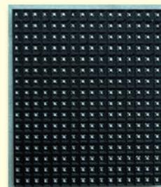
**Рисунок 3 Светодиодный модуль**
