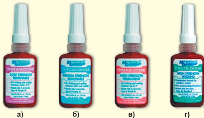
**Рисунок 6** Резьбовой клей: малой прочности для резьбы до 6.35 мм (а); средней прочности для резьбы до 19.05 мм (б); высокой прочности для резьбы до 25.4 мм (в); высокой прочности капиллярный для резьбы до 25.4 мм (г)
